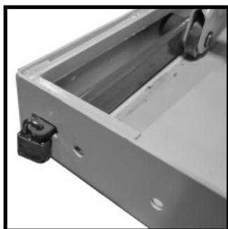
Barra de mantenimiento de elevación (posición asegurada con candado)
